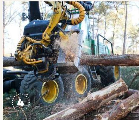
**4.** Die Maschine fällt den Baum, entfernt Äste und sägt den Stamm in Teile.
